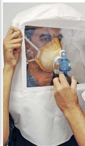
Рис. 4. Перевірка відповідності маски формі та розмірам обличчя працівника та його вміння правильно надягати респіратор (людина не повинна відчувати смак розчину солодкої/гіркої речовини, що розпорошується під капюшон)
