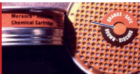
Рис. 2. Пасивний індикатор закінчення строку служби протигазового фільтра ESLI (при насиченні сорбенту парами ртуті коло в центрі змінює колір з оранжевого на коричневий)
