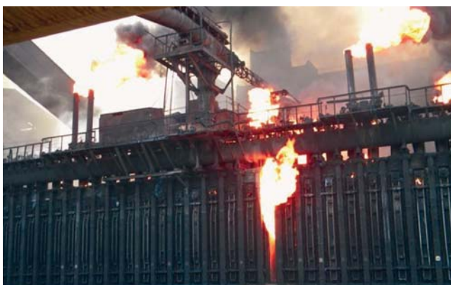
Рис. 6. Пожежа на коксовій батареї з незакритою піччю
