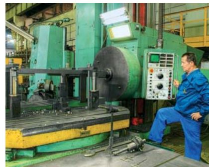
Пульт дистанційного керування розточувальним верстатом
