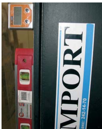
Фото 3. Визначення кута нахилу вантажопідіймача назад
