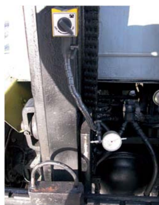
Фото 1. Визначення зазору між напрямними та роликами у поперечному напрямку вантажопідіймача
