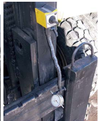
Фото 2. Визначення зазору між напрямними та роликами у поздовжньому напрямку вантажопідіймача
