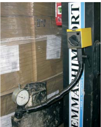
Фото 4. Визначення швидкості мимовільного опускання каретки вантажопідіймача під вантажем
